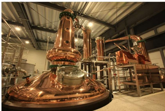
蒸溜釜は、ボールネックが山鹿灯籠をイメージさせるバルジ型のポットスチルを使用
